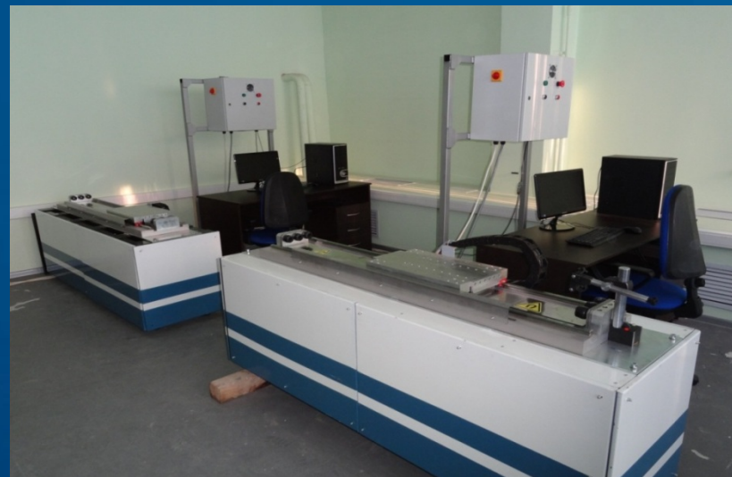
Опытные образцы стендов на основе ПЛЭ мощностью 4 и 8 кВт
