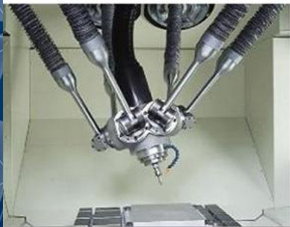
Универсальный обрабатывающий центр PM-600 на базе гексапода фирмы OKUMA
